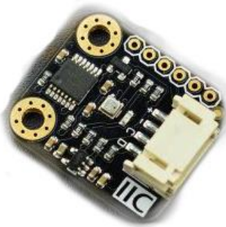
Εικόνα 5 DFROBOT I2C Environmental Sensor (BME280 Bosh)
